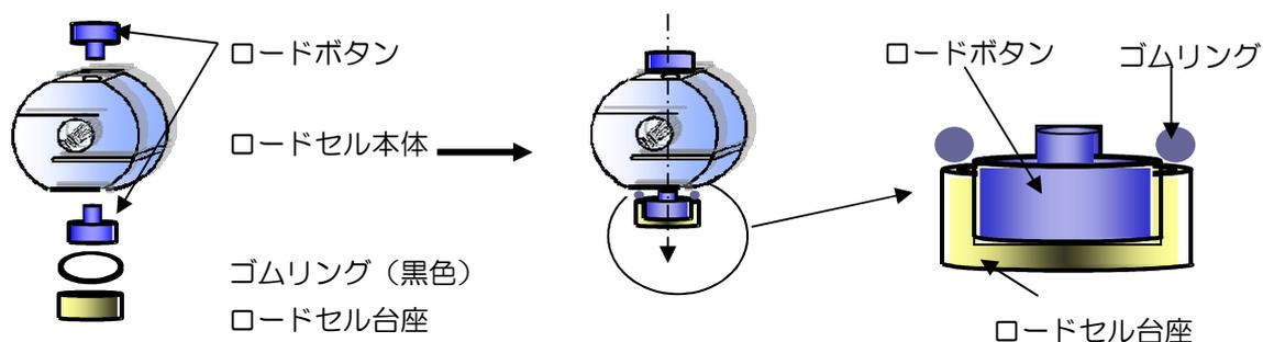
\*ロードボタン・ゴムリング・ロードセル台座は取付金具 (PR6043) に付属
